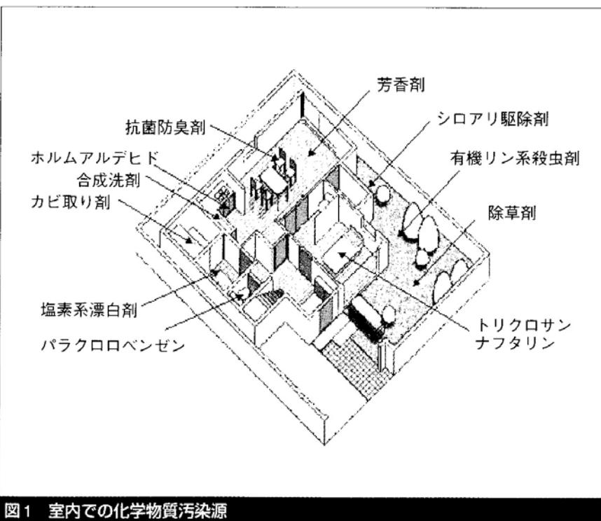
図1 室内での化学物質汚染源
