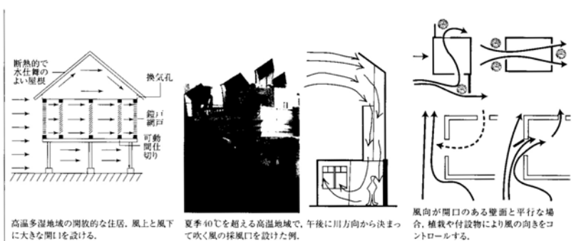
高温多湿地域の開放的な住居。風上と風下で大きな開口を設ける。夏季40℃を超える高温地域で、午後には川方向から決まって吹く風の採風口を設けた例。
