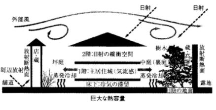
植栽や水面を有して低温域を形成する二つの中庭の空間ボリュームの違いによって生じる圧力差を利用して、室内に風を発生させ、深い軒庇、葺や高層によって日射を遮蔽している京都の町家。<sup>19)</sup>
