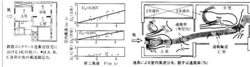
風は風上開口と風下開口を結ぶ線に沿って通風輪道を生じる。そこでの風速は外部の風速に比例し、通風率(=室内風速/外部風速)は一定となる。しかし、間仕切り開口で残る他の通風輪道からはずれる室の風速は、外部の風速に関係なく非常に弱い。通風時の風速分布は複雑であり、通風輪道の風は同じ室内の隣接空間に二次気流を派生させる。
