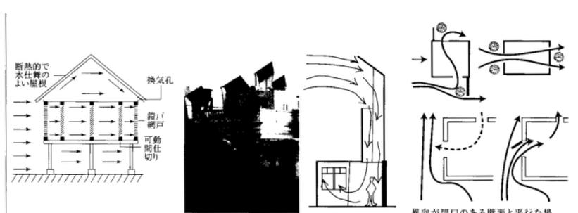
高温多湿地域の開放的な住居。風上と風下で大きな開口を設ける。夏季40℃を超える高温地域で、午後に川方向から決まって吹く風の採風口を設けた例。
